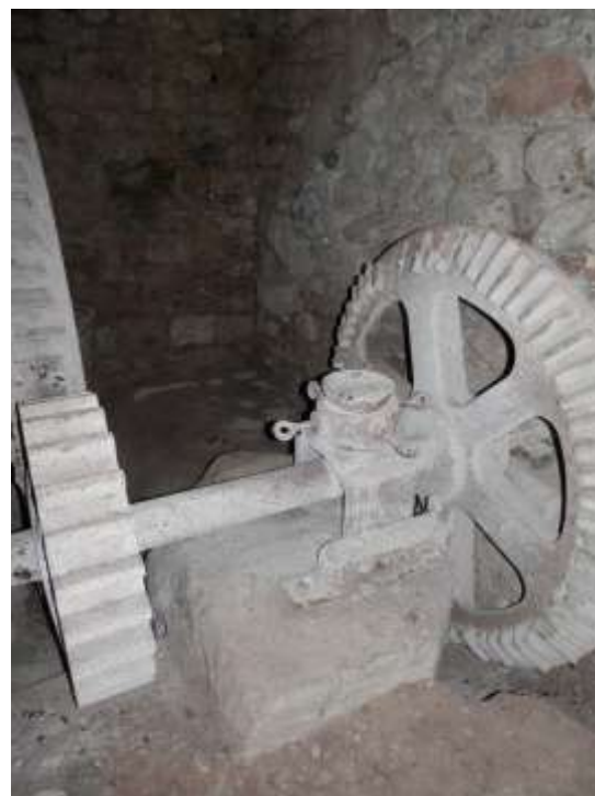
Entrainement de la roue crantée, de l'autre côté du mur.
