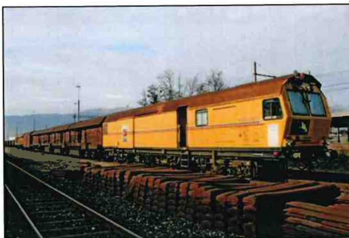
Train meuleur de rails (Scheuchzer S.A.)
