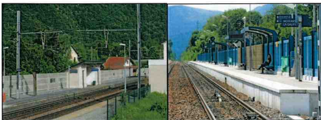
Exemples d'écrans acoustiques à Aiguebelle et Moirans
